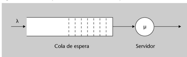
Aquí se muestra una fuente generadora de datos y una cola de espera donde se acumularán las unidades de datos esperando a ser atendidas por un servidor. Tanto el proceso de llegada de las unidades al sistema como el proceso de servicio son dos procesos estocásticos. Hay dos parámetros que hay que tener en cuenta: la disciplina con que se generan los datos y la disciplina con que se sirven. El término *disciplina* hace referencia a cuáles son los parámetros estadísticos de estos elementos.
